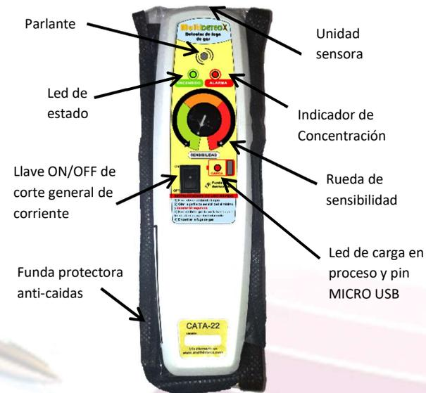
Para encender el equipo asegúrese de estar ubicado en un ambiente libre de contaminantes. Para comenzar a utilizar el detector primero gire la rueda de sensibilidad en sentido antihorario, sentido del mínimo valor de sensibilidad (signo -), hasta hacer tope, y luego presione la tecla de encendido, el equipo encenderá su led verde de estado y comenzará el auto testeado de encendido donde el equipo puede sonar hasta por 60 segundos.
