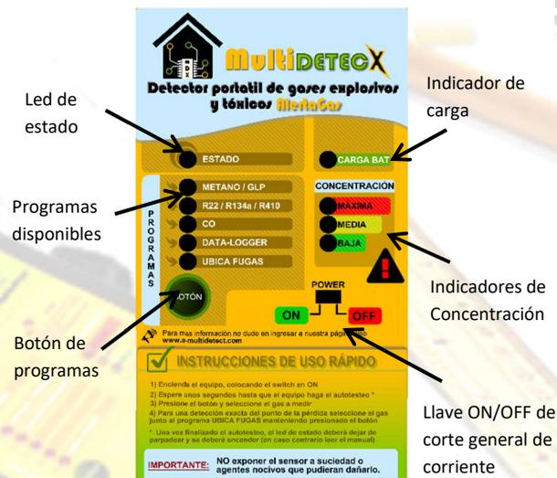
Para encender el equipo coloque la tecla de encendido en ON (OFF para apagarlo), el equipo comenzará el auto testeo haciendo titilar el led de estado por al menos 50 segundos. Una vez que el led de estado verde se estabiliza, se encenderá el primer led rojo de los programas disponibles indicando que el equipo queda en modo de búsqueda de fugas del gas en cuestión.
